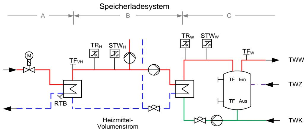
Abbildung 9: Hauszentrale-Trinkwassererwärmung
