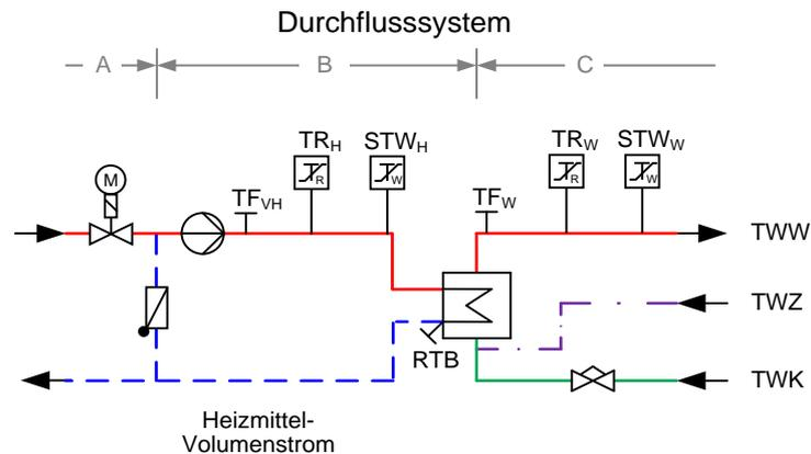
Abbildung 8: Hauszentrale-Trinkwassererwärmung Prinzipschaltbilder für den direkten Anschluss mit Beimischregelung
